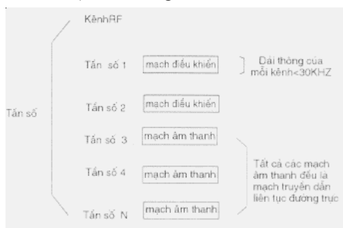
Hình 2.35 (truncated). 1 mạch trên một mạch RF
